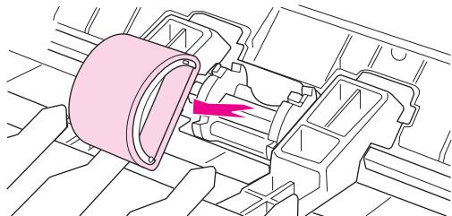
6. Positionieren Sie die neue Papiereinzugswalze in der Öffnung. Die kreisförmigen und rechteckigen Aussparungen an der Seite verhindern ein falsches Einsetzen der Walze.
