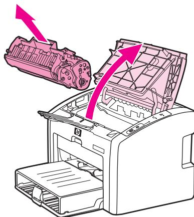
3. Entfernen Sie alle Rückstände im Medienpfad, und in der Einbuchtung für die Druckpatrone mit einem trockenen, fusselfreien Tuch.
