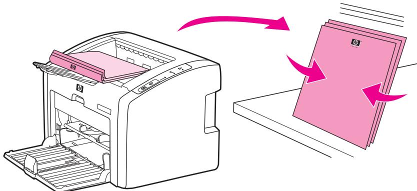
5. Legen Sie die Blätter mit der ersten Seite wieder in das Zufuhrfach. Die erste Seite sollte nach unten zeigen, und die untere Kante sollte dem Drucker zuerst zugeführt werden.
