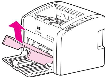
2. Schieben Sie die Medienführungen etwas über die Breite der Umschläge hinweg nach außen, bevor Sie die Umschläge einlegen.
