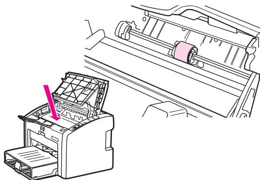
4. Lösen Sie die kleinen, weißen Laschen an beiden Seiten der Papiereinzugswalze, und drehen Sie die Papiereinzugswalze nach vorne.
