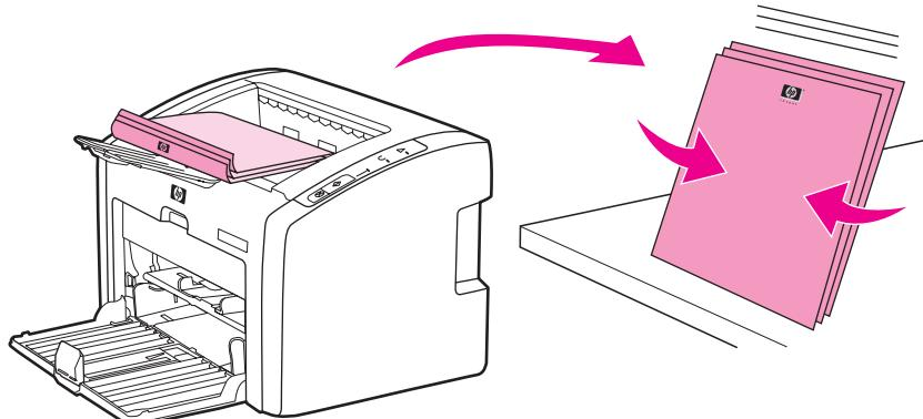
5. Legen Sie den Stapel wieder in das Zufuhrfach. Die erste Seite sollte nach unten zeigen, und die untere Kante sollte dem Drucker zuerst zugeführt werden. Bringen Sie die Abdeckung des Medienzufuhrfachs wieder an.
