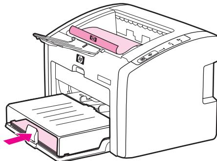
4. Nachdem eine Seite gedruckt wurde, nehmen Sie die bedruckten Blätter heraus. Drehen Sie die bedruckte Seite nach unten, und richten Sie den den Stapel gerade.
