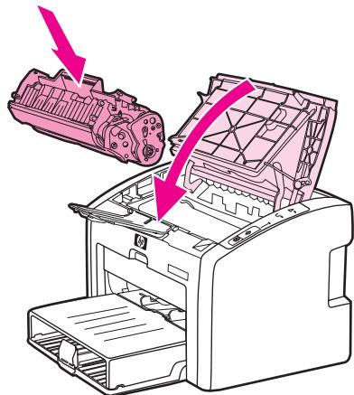
Falls der Ausdruck immer noch hell ist, legen Sie eine neue Druckpatrone ein. Weitere Anweisungen finden Sie unter [Auswechseln der Druckpatrone](#).
