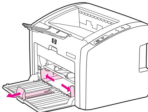
3. Legen Sie die Umschläge mit der zu bedruckenden Seite nach oben und der oberen Kante nach links in die Medienführung ein. Sie können bis 15 Umschläge übereinander stapeln.
